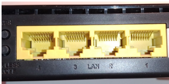
Porte LAN del router (di solito 4 e di colore giallo)
